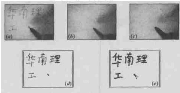
图 4  $7 \times 7$  模板的形态学处理结果. (a) 原图; (b) 膨胀后的图像; (c) 腐蚀后的图像; (d) 相减并取反后的图像; (e) 二值化结果
